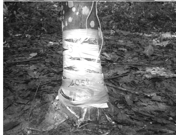
Photos 1 : Préparation du micropsychromètre de Dixon-Tyree pour les mesures de potentiel hydrique du xylème au niveau de la jonction de greffage ( \Psi_{\text{tronc}} et \Psi_{\text{racines}} ). Setting of the Dixon-Tyree stem hygrometer into level of the grafting junction for measurements of xylem water potential ( \Psi_{\text{stem}} and \Psi_{\text{roots}} bars).
